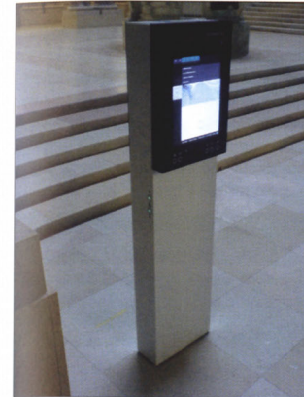
Das behindertengerechte Display lässt sich absenken und fährt bei Nichtbenutzung automatisch in die Ausgangsposition zurück. (Bilder: WES Ebert Systeme Electronic)
